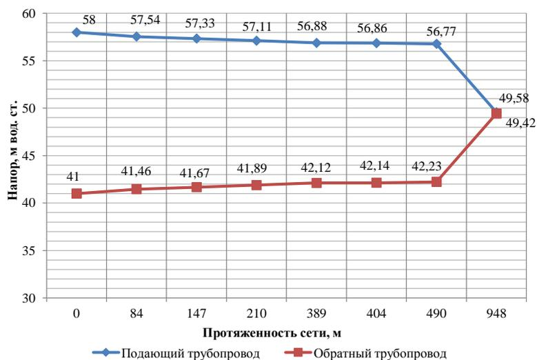
Рис. 1.11. Пьезометрический график тепловой сети ООО «УК «Томскосельское»
