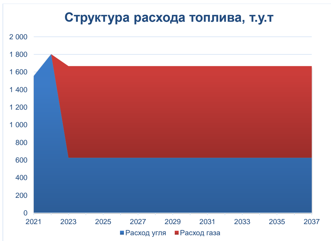
Рисунок 10.1 – Прогнозные расходы топлива на котельных Итатского СП
